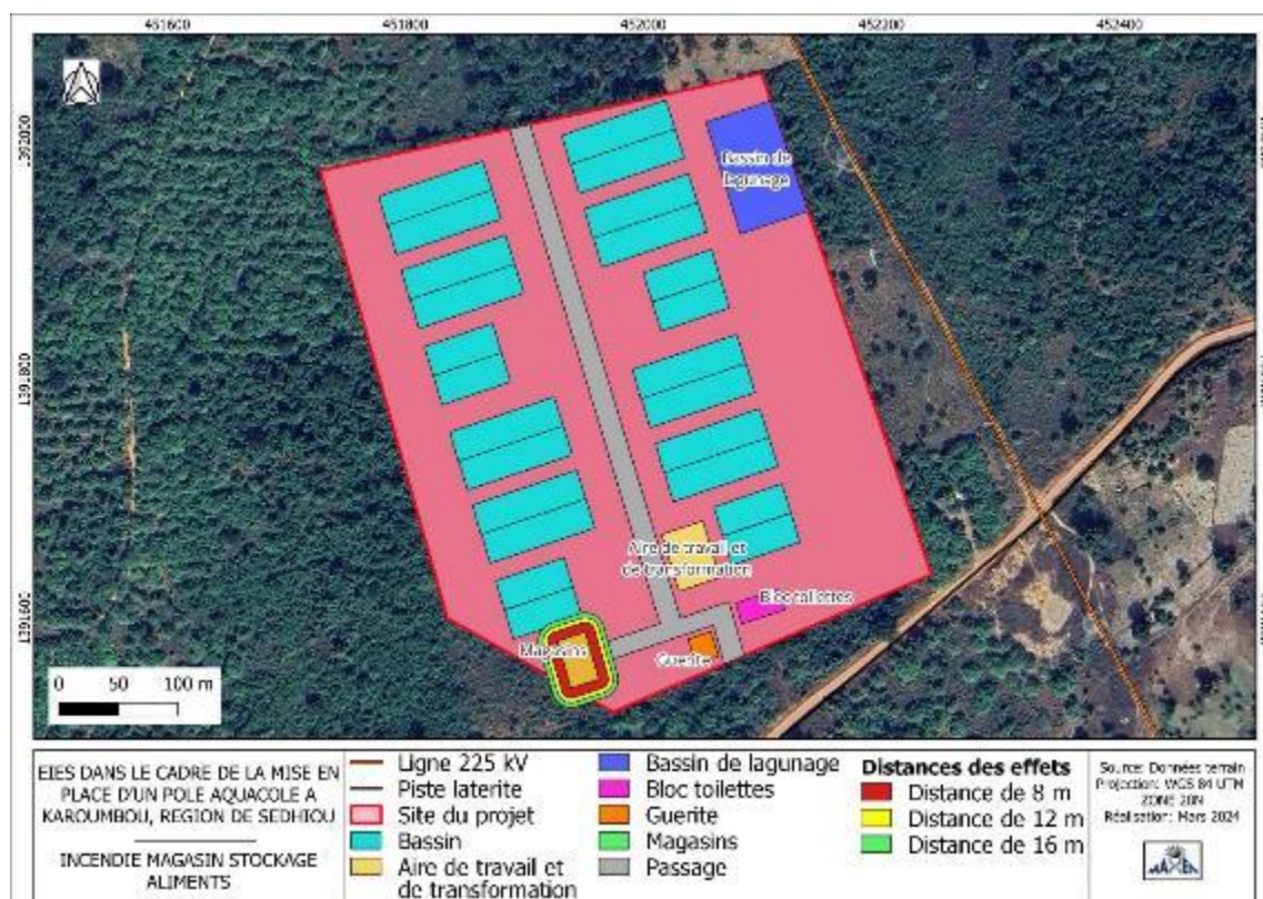
Figure 28: distances des effets thermiques incendie magasin de stockage
