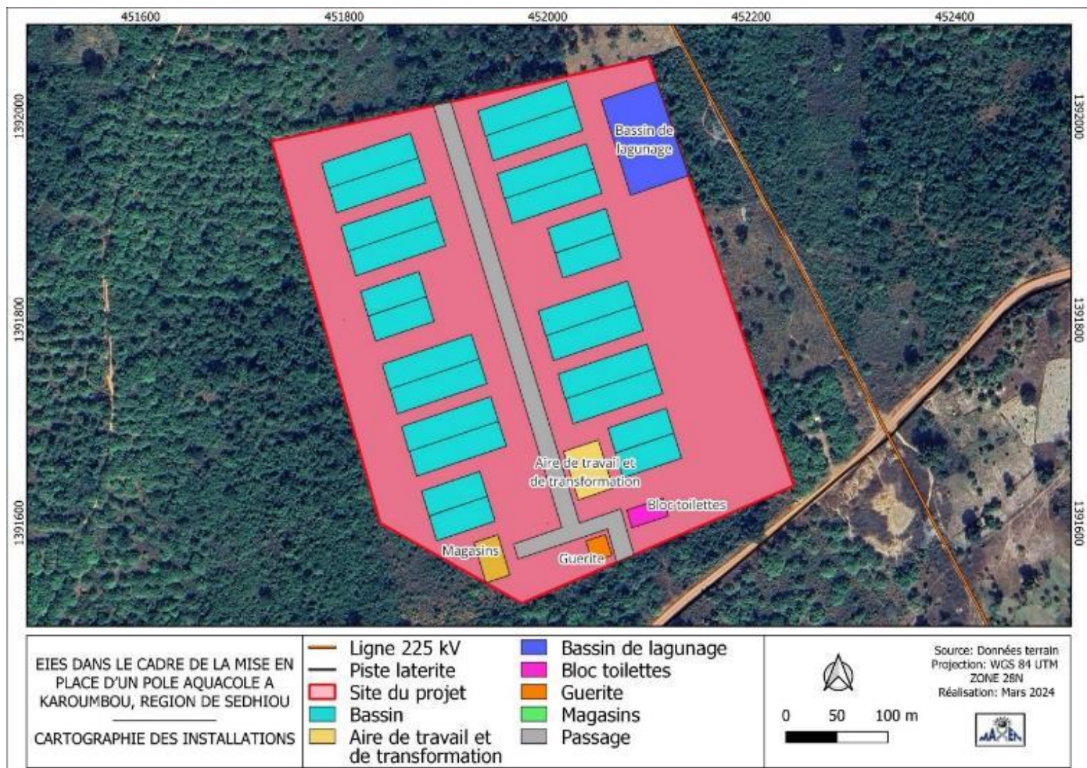
Figure 1: installations prévues par le projet
