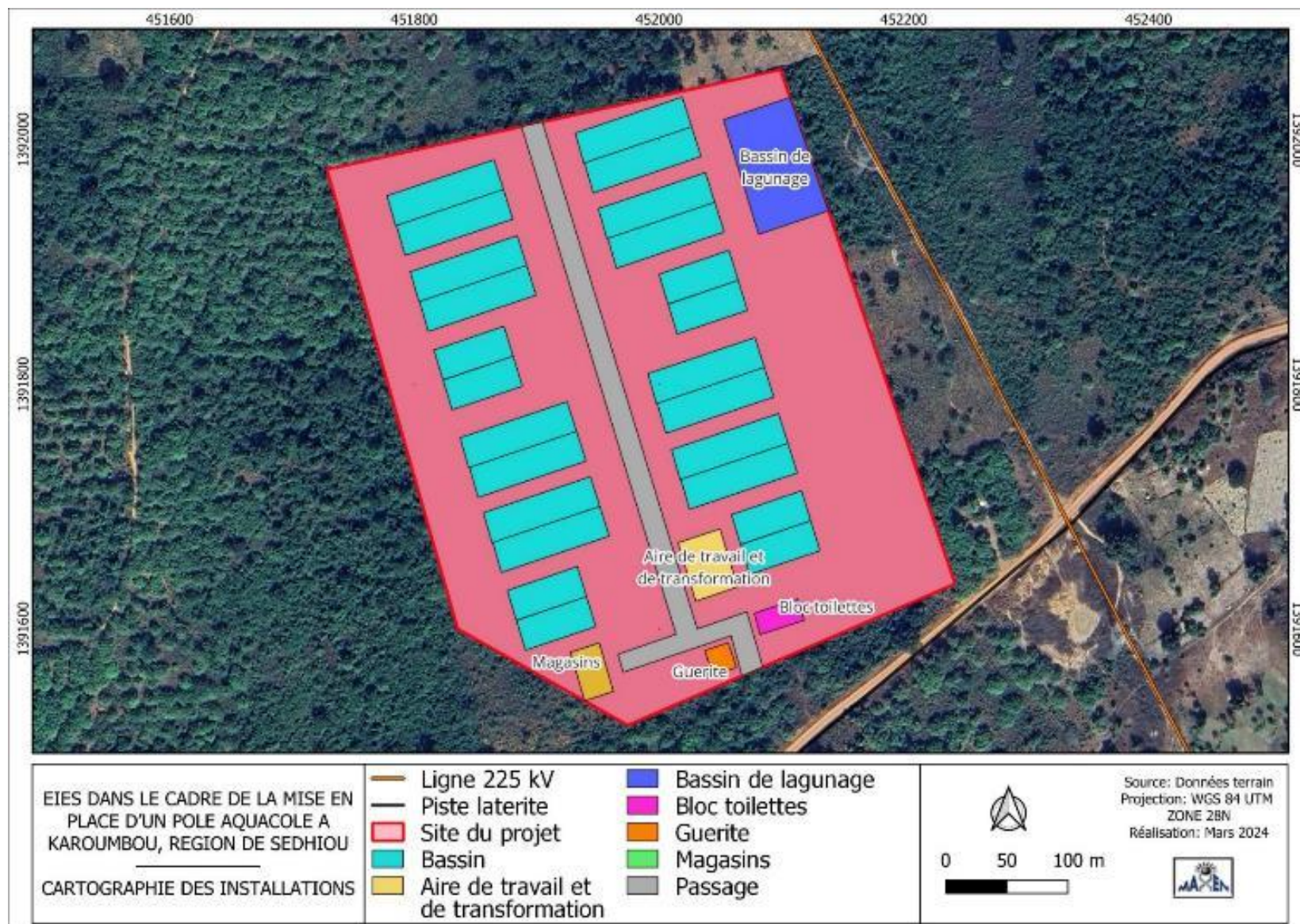
Figure 7: Carte des installations prévues par le projet
